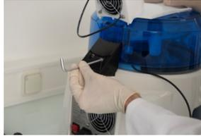
6. Brancher respectivement le connecteur du ventilateur et de la sonde de température au dos du Precellys® Evolution.
