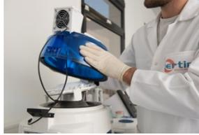
6. Remettre le module sur le capot diffuseur, placer l'ensemble dans la protection en mousse inférieure et sur l'emballage à rabats
