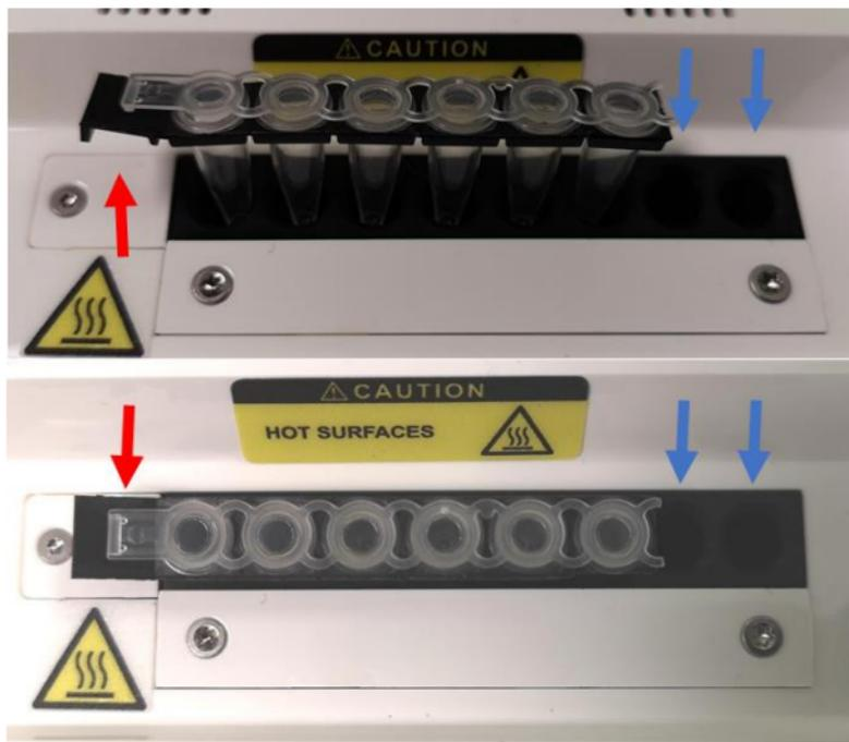
*Figure 8: Insertion de la barrette de micro-tubes dans l'incubateur-lecteur. Les flèches rouges indiquent la position du détrompeur noir à l'extrémité gauche du support de micro-tubes. Les flèches bleues indiquent les positions 7 et 8 laissées vides.*
