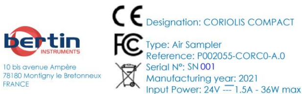
Figure 5 : Modèle de plaque d'identification du Coriolis Compact
