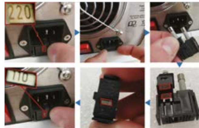
Figure 2 : Instructions pour l'adaptation de l'appareil au courant électrique (220V/110V)
