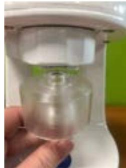
3- Verrouiller la bague de serrage en la tournant vers la droite (pas à plus de 180°), jusqu'à ressentir une résistance
