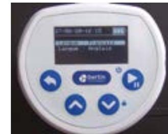
**3. Mode Veille :** Permet d'activer le mode veille de l'appareil en utilisant les flèches
