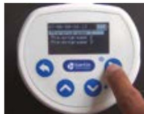
3- Définir les paramètres en utilisant le bouton play pour valider et les flèches pour sélectionner les bonnes valeurs (durée, délai)
