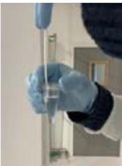
6- Agiter manuellement l'échantillon par retournement (ou à l'aide d'un vortex si équipement à disposition) et refermer le cône à l'aide du bouchon. L'échantillon est prêt à être analysé
