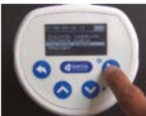
3- Définir les paramètres en utilisant le bouton play pour valider et les flèches pour sélectionner les bonnes valeurs (durée, délai, nb de cycle et pause)
