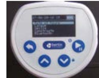
**1. Date et heure :** Permet le réglage de la date et de l'heure en utilisant les flèches
