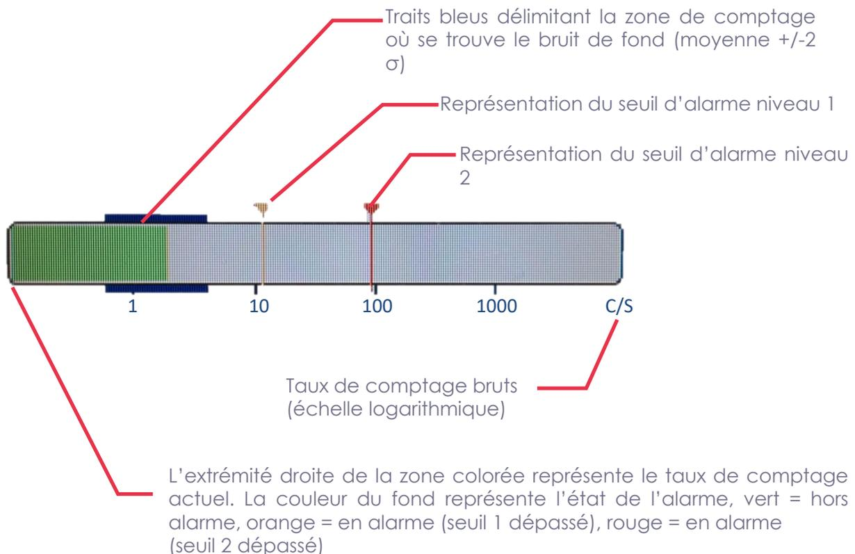
L'observation de l'indication du taux de comptage (extrémité droite de la zone colorée ci-dessus) sur le bargraphe permet de déterminer si on commence à détecter une petite contamination.
